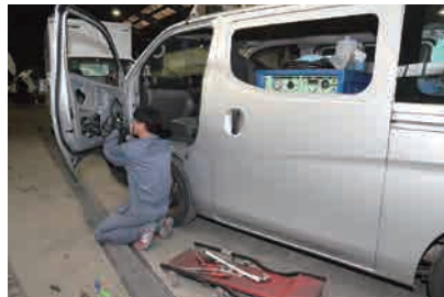
▲ドア取り付け作業
