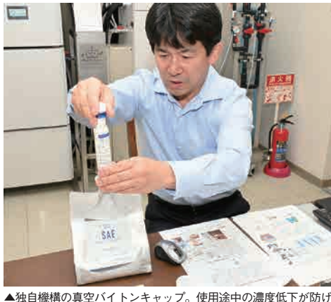
▲独自機構の真空バイトンキャップ。使用途中の濃度低下が防げ長期保存・使用が可能
